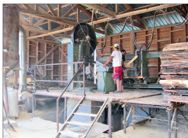
Mit einer Gatter- und einer Bandsäge (oben) schneidet die Firma Minithechnicus jährlich rund 9000 bis 10000 Fm Robinie.
