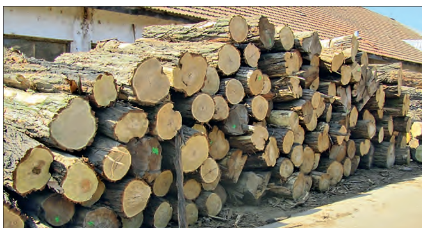
Der Rohstoff Robinie. Das Rundholz wird überwiegend in Ganzlängen bis 9 m angeliefert und im Sägewerk ausgeformt.
