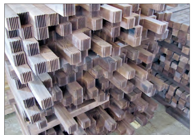
Keilgezinkte Kanteln vor der Verleimung, dunkel gedämpft für die Herstellung von Leimholzplatten.
