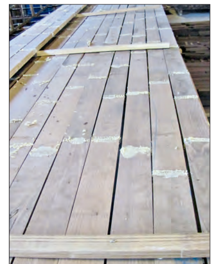
Keilgezinkte Robiniendecks für die Terrasse vor dem Hobeln. An den Keilzinkstößen sieht man noch Klebstoffreste.
